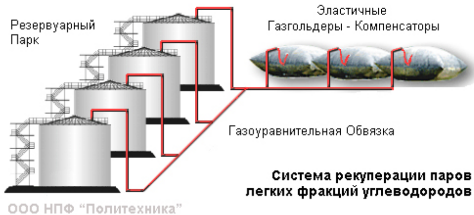
Принципиальная схема подключения эластичных газгольдеров-компенсаторов
